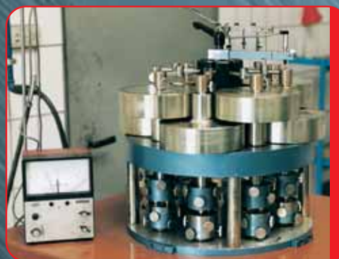
Banc d'essai à huit colonnes selon le principe broche/rondelle, pour l'examen de couples de friction mixte et à sec, à des vitesses faibles et sous des pressions de surfaces élevées.
