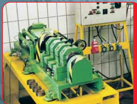
Banc d'essai VLP 84 à quatre paliers, construction Prof. Spiegel, pour l'épreuve de paliers lisses lubrifiés à la graisse.
