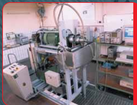
Un banc d'essai spécialement conçu pour les paliers grandes vitesses, permet de déterminer des résultats réels sur prototypes.
